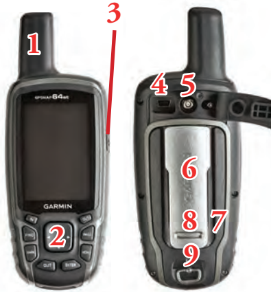
A Garmin GPSMAP 64st készülék részei
