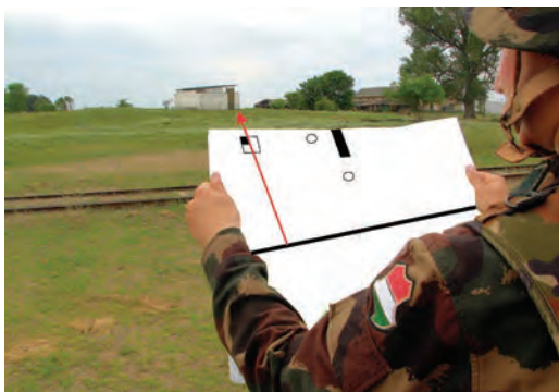
Álláspont meghatározása oldalmetszéssel
